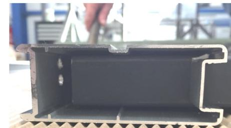
Perçages écoulement des eaux
