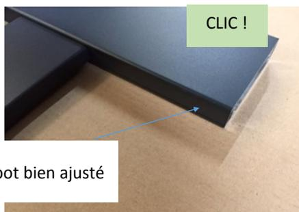
7. Dans le cas présent, **toutes les images présentent un montage refoulement à droite** vue intérieure, il vous suffit d'inverser droite gauche pour un refoulement à gauche vue intérieure. Présenter les traverses en face des mortaises (trous). La paroi la plus épaisse de la traverse doit être vers le haut .
