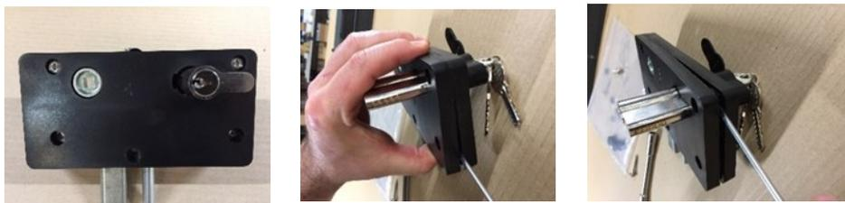
2. Retirer la pièce métallique qui bloque le pêne et retirer le pêne et le ressort et remettre la pièce métallique, refermer le boîtier et remettre les vis retirées préalablement
