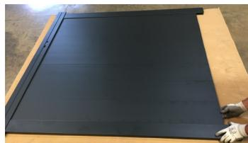
12. **OPERATION DELICATE !** Présenter ensuite le montant serrure (qui a des perçages pour recevoir la serrure et le barillet). Positionner la face rainurée vers le haut et procéder à l'emboîtement du montant serrure. L'utilisation d'un maillet est indispensable. Cette opération nécessite d'être 2 personnes, de part et d'autres du montant serrure.
