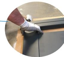
13. Difficultés pour assembler les panneaux et le montant serrure —> soulever délicatement, avec une main en-dessous, le panneau assemblé afin de l'aligner au montant. Faire entrer l'élément en butée dans la rainure du montant. Finir d'emboîter le montant à l'aide d'un maillet.
