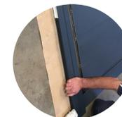
14. Placer le montant serrure en butée contre les traverses et réaliser le vissage : 2 vis 6,3 x 60 par traverse. Les têtes de vis doivent buter contre le montant. Les traverses doivent être en butée dans le montant. Vérifier les longueurs basses et hautes du vantail Si ces longueurs sont différentes, vérifiez les mises en butée de chaque élément.
