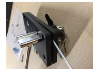
2. Retirer la pièce métallique qui bloque le pêne et retirer le pêne et le ressort et remettre la pièce métallique, refermer le boîtier et remettre les vis retirées préalablement
