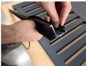
2. Présenter le battement dans le montant de gâche. Il se clippe. Le battement doit être positionné sous le chapeau du montant de gâche.
