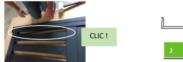
22. Placer le montant serrure en butée contre les traverses et réaliser le vissage : 2 vis 6,3 x 60 par traverse. Les têtes de vis doivent buter contre le montant. Les traverses doivent être en butée dans le montant. Vérifier les longueurs basses et hautes du vantail Si ces longueurs sont différentes, vérifiez les mises en butée de chaque élément.
