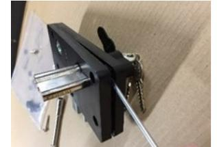
2. Retirer la pièce métallique qui bloque le pêne et retirer le pêne et le ressort et remettre la pièce métallique, refermer le boîtier et remettre les vis retirées préalablement
