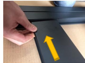
9. Visser chaque traverse à l'aide de 2 vis 6,3 x 60 et d'un embout PH inclus. Les têtes de vis doivent buter contre le montant. Les traverses doivent être en butée dans le montant. 2 perçages doivent rester libres : ce sont des perçages pour l'écoulement des eaux de pluie et de condensation .
