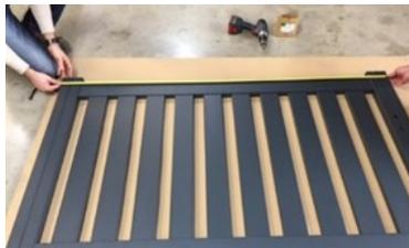
7. Présenter les traverses simples 102 X 30 mm en face des mortaises (trous) haute et basse. La paroi la plus épaisse de la traverse doit être vers le haut (épaisseur nécessaire à la fixation de pattes pour motorisation). Attention au sens d'emboîtement
