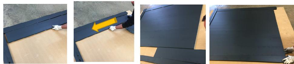
14. **OPERATION DELICATE !** Présenter ensuite le montant serrure (qui a des perçages pour recevoir la serrure et le barillet). L'utilisation d'un maillet est indispensable. Commencer cette opération par la traverse basse et procéder en « remontant ». Visser sur les 2 traverses à l'aide des vis 6.3 x 60mm
