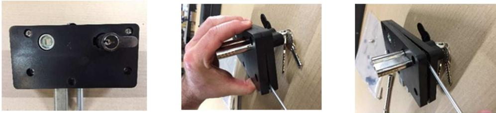
2. Retirer la pièce métallique qui bloque le pêne et retirer le pêne et le ressort et remettre la pièce métallique, refermer le boîtier et remettre les vis retirées préalablement
