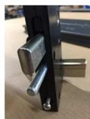
23. Positionner la serrure dans le montant et pré-percer à l'aide d'un foret de diam 4mm maxi, puis visser à l'aide des 3 vis 4.8 x 32 mm
