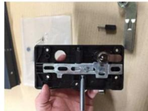
3. Monter l'avaloir sur la pièce de réception avec une vis M8-20 et l'écrou M8.
