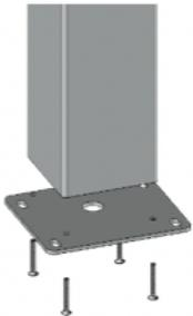
Fissare il palo a terra mediante sigillatura chimica (barre filettate di diametro 10 mm) o mediante tasselli in acciaio (diametro 10 mm) a seconda delle esigenze.
