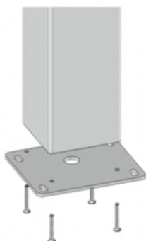
4) Fissare il palo a terra mediante sigillatura chimica (barre filettate di diametro 10 mm) o mediante tasselli in acciaio (diametro 10 mm) in base alle proprie esigenze.
