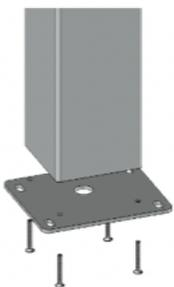
2) Fissare il palo a terra mediante sigillatura chimica (barre filettate di diametro 10mm) o mediante tasselli in acciaio (diametro 10mm) in base alle proprie esigenze.
