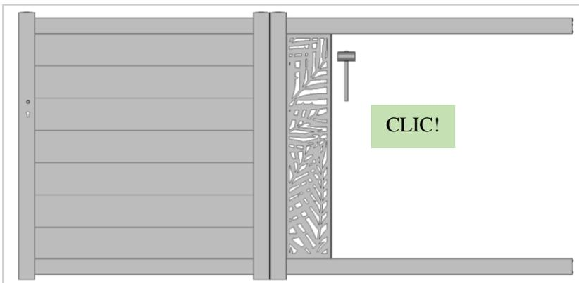
Incastrare la lamiera utilizzando il mazzuolo: la copertura smerlata deve fissarsi sul montante.
