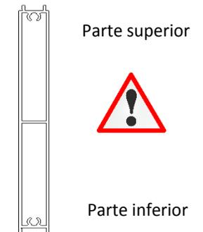
4. Sitúe el otro poste sin fijarlo y marque los orificios a realizar. Retire el poste y la primera lama. Fije el segundo poste.
