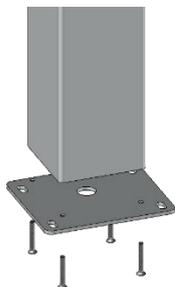
Fixez le poteau au sol par scellement chimique (tiges filetées de diamètre 10 mm) ou à l'aide de chevilles en acier (diamètre 10mm) selon vos besoins.
