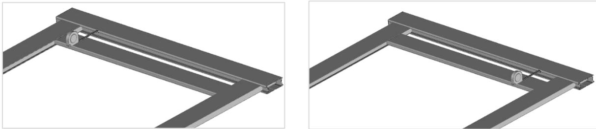
14. Clipper ensuite les capots d'entretoise **N** (21 x 9 mm) dans chaque traverse. Renouveler l'opération en alternant barreaux (95 x 20 mm) et capot d'entretoise (21 x 9 mm).
