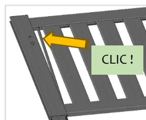
21. Placer le montant serrure en butée contre les traverses et réaliser le vissage : 2 vis (6,3 x 60) par traverse. Les têtes de vis et les traverses doivent buter dans le montant. Vérifier les longueurs basses et hautes du vantail. Si ces longueurs sont différentes, vérifiez les mises en butée de chaque élément.
