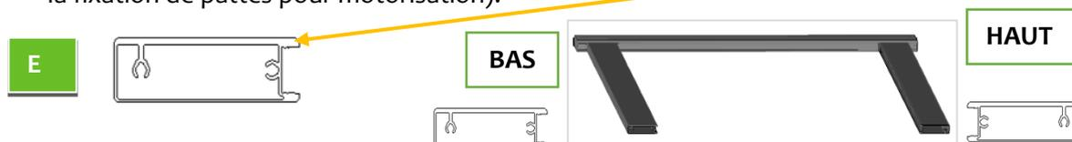
Procéder à l'emboîtement de chaque traverse dans les mortaises (trous) en soulevant légèrement l'extrémité du profil pour faciliter l'opération. Les traverses doivent être glissées dans le montant en butée.
