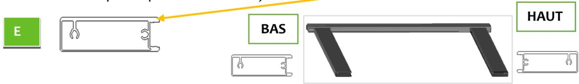
Procéder à l'emboîtement de chaque traverse dans les mortaises (trous) en soulevant légèrement l'extrémité du profil pour faciliter l'opération. Les traverses doivent être glissées dans le montant en butée.
