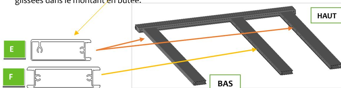
9. Visser chaque traverses **E** à l'aide de 2 vis (6,3 x 60) et d'un embout PH2 ou d'une clé à pipe de 10. Les têtes de vis et les traverses doivent buter dans le montant. Les deux petits perçages doivent rester libres : ce sont des perçages pour l'écoulement des eaux de pluie et de condensation.
