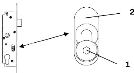
A l'aide de la clé hexagonale (fournie), desserrer de quelques tours la vis 1, déplacer la pièce 2 vers le bas puis resserrer la vis 1.
