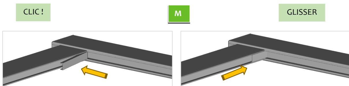
11. Clipper le capot de montant **K** (21 x 9 mm) sur le montant d'extrémité.
