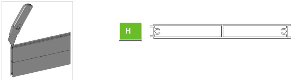
11. Faire glisser les panneaux de remplissage un à un le long du montant. Le premier doit entrer en butée dans la traverse et les autres suivent.
