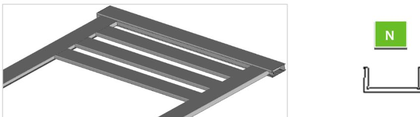
15. Clipper ensuite les capots d'extrémités **M**. Ils ne doivent pas dépasser de la traverse. S'ils dépassent, vérifier que l'ensemble capots d'extrémités, barreaux **G** (95 x 20 mm) et capots d'entretoises **N** (21 x 9 mm) soient en butée sur toute la longueur de la traverse.
