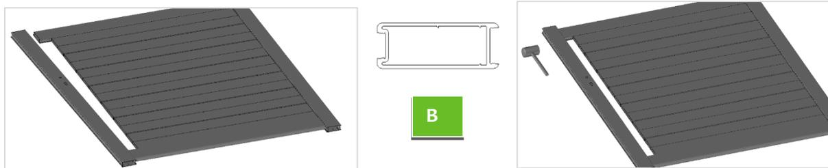
13. Si difficultés pour assembler les panneaux et le montant serrure : soulever délicatement, avec une main en dessous, le panneau assemblé afin de l'aligner au montant. Faire entrer l'élément en butée dans la rainure du montant, puis finir d'emboîter le montant à l'aide d'un maillet.
