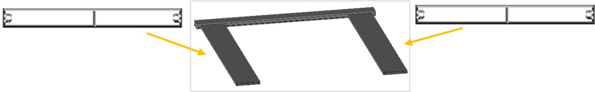
Procéder à l'emboîtement de chaque traverse dans les mortaises (trous) en soulevant légèrement l'extrémité du profil pour faciliter l'opération. Les traverses doivent être glissées dans le montant en butée.
