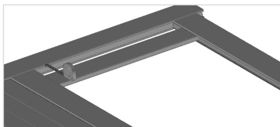
17. Clipper ensuite les capots d'entretoise **N** (21 x 9 mm) dans chaque traverse. Renouveler l'opération en alternant barreaux (95 x 20 mm) et capot d'entretoise (21 x 9 mm).
