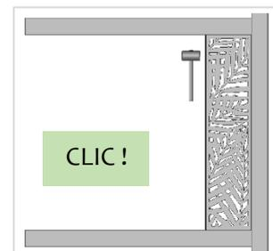
Emboîter la tôle **N** à l'aide du maillet : le capot de tôle **M** doit se clipper sur le montant.
