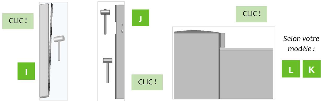
2. Insérer la serrure dans le montant et visser le barillet. **Pré-percer** à l'aide d'un foret de diamètre 4mm, puis le fixer à l'aide des vis 4,8 x 25 TF fournies. Terminer par la poignée.
