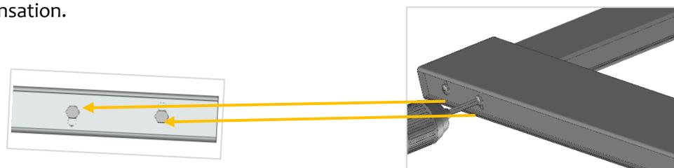
10. Glisser les 2 capots d'extrémités **M** (21 x 9 mm) sur les traverses **E**, en haut et en bas. Ils doivent être positionnés en butée dans le montant d'extrémité.
