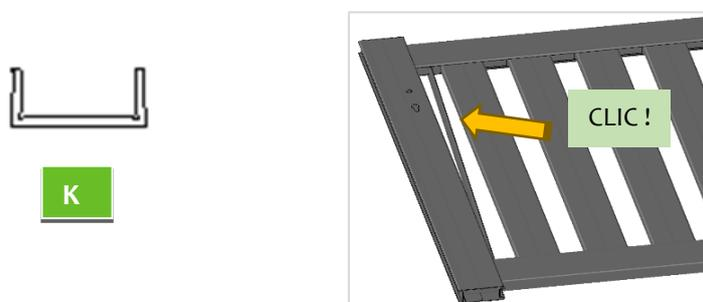
18. Placer le montant serrure **B** en butée contre les traverses et réaliser le vissage : 2 vis (6,3 x 60) par traverse. Les têtes de vis et les traverses doivent buter dans le montant. Vérifier les longueurs basses et hautes du vantail. Si ces longueurs sont différentes, vérifiez les mises en butée de chaque élément.
