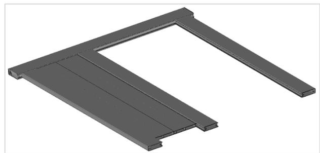
13. Glisser les 2 capots d'extrémités **M** (21 x 9 mm) sur les traverses, en haut et en bas. Ils doivent être positionnés en butée dans le montant d'extrémité **A**.
