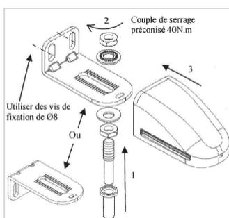
7. Pose du sabot central : aligner vos deux vantaux afin que l'ensemble soit rectiligne (voir pointillés sur l'image ci-dessous) repérer et fixer le sabot. Adapter la fixation en fonction de la nature de votre seuil.
