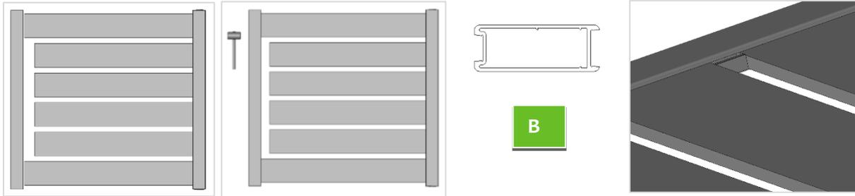
Si difficultés pour assembler les panneaux et le montant serrure : soulever délicatement, avec une main en dessous, le panneau assemblé afin de l'aligner au montant. Faire entrer l'élément en butée dans la rainure du montant, puis finir d'emboîter le montant à l'aide d'un maillet.
