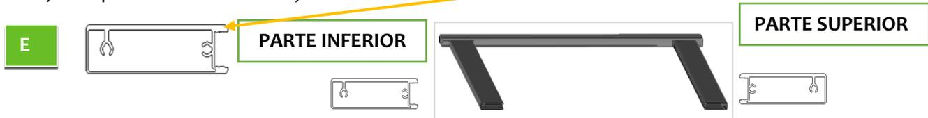
Encaje cada travesaño en las mortajas (orificios), levantando ligeramente el extremo del perfil para facilitar la operación. Los travesaños deben deslizarse haciendo tope en el montante.
