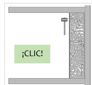
Encaje la chapa **N** con el mazo: la cubierta de chapa **M** debe encajar en el montante.
