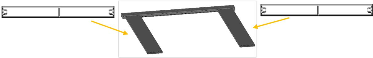
Encaje cada travesaño en las mortajas (orificios), levantando ligeramente el extremo del perfil para facilitar la operación. Los travesaños deben deslizarse haciendo tope en el montante.
