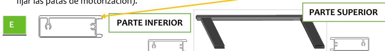
Encaje cada travesaño en las mortajas (orificios), levantando ligeramente el extremo del perfil para facilitar la operación. Los travesaños deben deslizarse haciendo tope en el montante.
