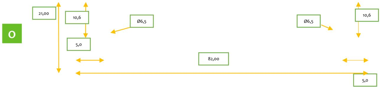
5. Atornille 1 cubierta **O** preparada en el paso 4 en cada extremo del mainel **L** con tornillos (6,3 x 60).
