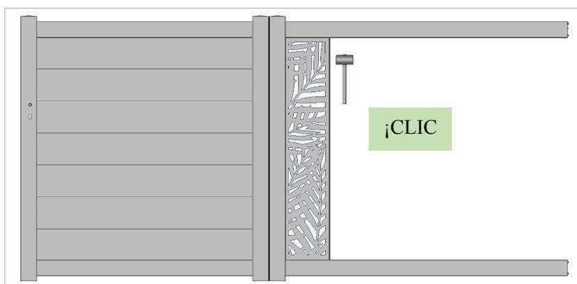
Encaje la chapa con el mazo: la cubierta de chapa M debe encajar en el montante.
