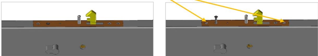
8. Instale la **manilla**, palanca larga en el interior de la propiedad en horizontal y la palanca corta en el exterior en vertical.
