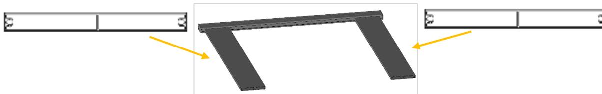
Incastrare ciascuna traversa nelle mortase (fori), sollevando leggermente l'estremità del profilo per facilitare l'operazione. Le traverse devono essere fatte slittare nel montante a battuta.
