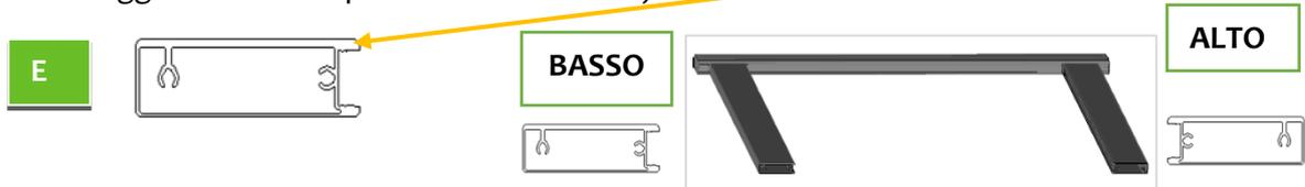
Incastrare ciascuna traversa nelle mortase (fori), sollevando leggermente l'estremità del profilo per facilitare l'operazione. Le traverse devono essere fatte slittare nel montante a battuta.
